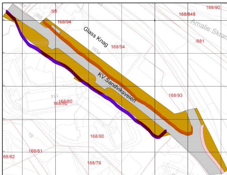
Figur 3-5: Illustrasjon som viser mulige løsninger som ivaretar myke trafikanter på strekningen, der rød farge viser mulig etablering av fortau og lilla farge viser eksisterende gangveg.
